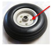
Même opération pour l'autre demi jante avec les écrous Serrez les fermement
