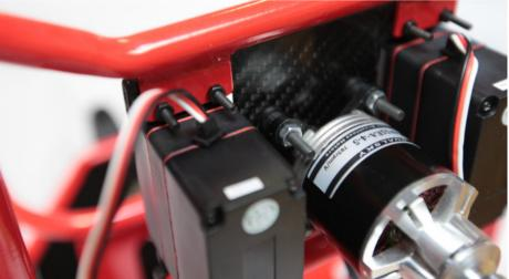
Remettre ensuite les 8 écrous pour maintenir la platine moteur en position.
