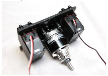
Les servomoteurs ainsi que le moteur de propulsion sont installés, vous pouvez désormais les fixer sur le châssis.
