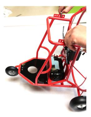
La batterie de propulsion doit être positionnée comme sur cette photo. Le centre de gravité est ainsi optimisé, et permet un emport de charge allant jusque 3000gr sur la partie avant du chariot.
