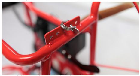
Le chariot comporte plusieurs trous de réglage pour la fixation de la voile. Comment choisir la position de la boucle ?
