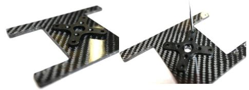
A l'aide d'un outils pointu, effectuez les repères de perçage conformément à la géométrie de votre croisillon, puis percez la platine à l'aide d'une perceuse.
