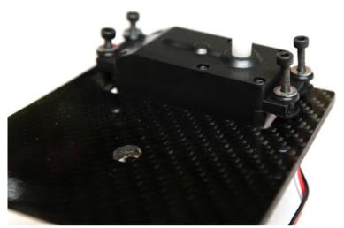
Installez ensuite les 4 vis CHC avec leur rondelle. Positionnez le servo moteur sur la platine . Effectuez la même opération pour le  $2^{\rm e}$  servomoteurs.
