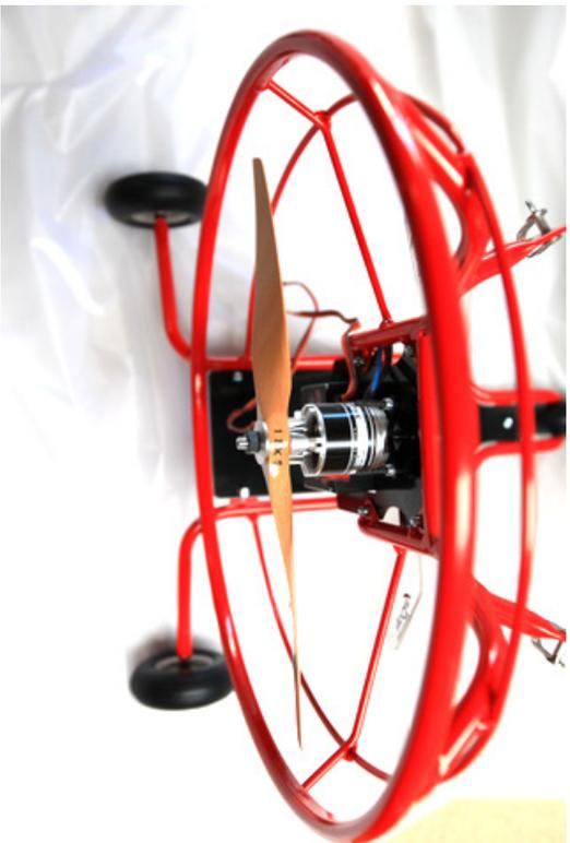
Pour la fixation du moteur, utilisez des vis GHG M2,15 minimum.
