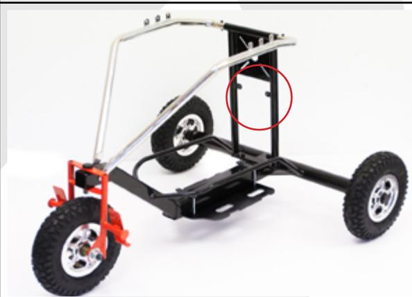
Installez la platine avec les servomoteurs sur le support vertical à l'aide de 4x Vis CHC M3-12 et 4 écrous freins
