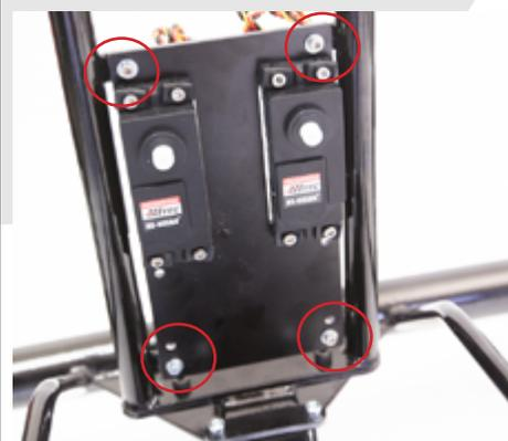
Monter la sangle comportant l'anneau en inox à l'aide d'une CHC M3-10, rondelle et écrou frein. La fixation du bras sur le palonnier du servomoteur se fait à l'aide de 2x CHC M3-8
