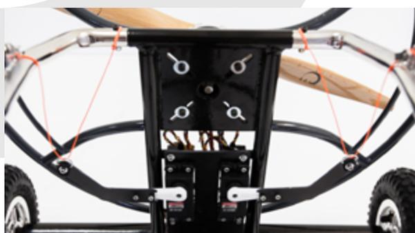
En utilisant le module de mixage pour paramoteur Rc (ref OP16782), les palonniers doivent être en position haute lorsque le manche de profondeur est en position neutre.
