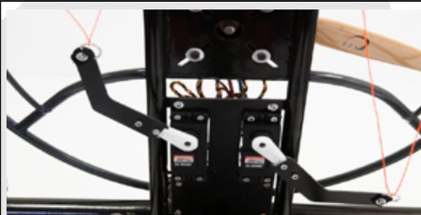
Manche des ailerons à droite, le servomoteur de droite descend en position basse maxi.
