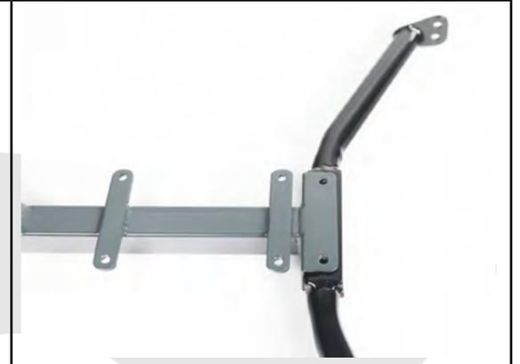
Préparer la platine support de batterie avec 2 vis CHC M4-30 avec rondelles. La positionner sur l'essieu arrière comme la photo ci-contre.
