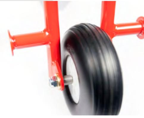
Fixer le train d'atterrissage avec la platine principale de votre Backpack L à l'aide de 4x vis CHC M4-18 + écrous freins M4 + rondelles M4.
