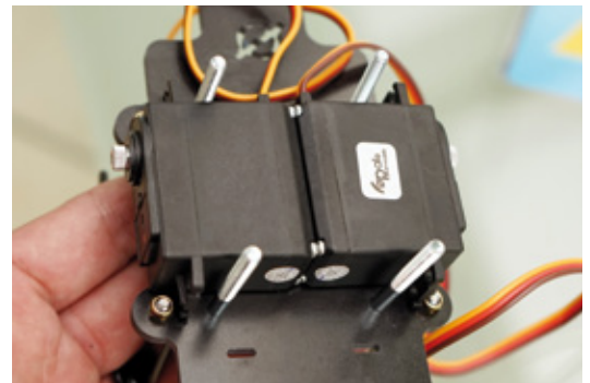
Die Steuerarme werden direkt auf die Servos geschraubt
