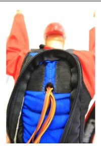
Fixer à l'extrémité du palonnier du servomoteur de speedbar une vis cruciforme (fournie avec le servomoteur)
