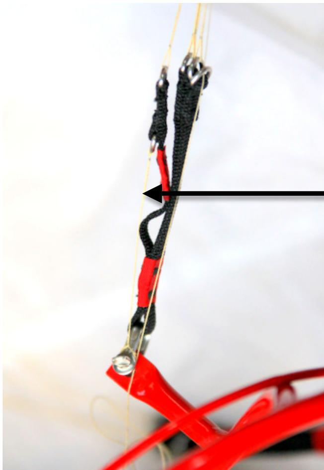
Le montage des élévateurs part du même principe que pour l'utilisation vol de pente. C'est à dire, la marque rouge située sur la sangle doit se trouver vers l'avant du chariot. Le nœud qui maintient la suspenste de frein doit être retiré, et la suspenste de frein doit passer librement dans l'anneau prévu à cet effet.
