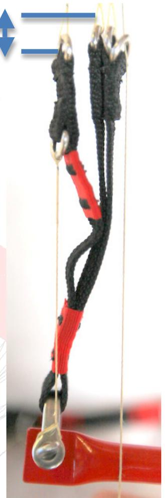
Vos élévateurs sont alors dans cette configuration, avec un décalage d'environ 10mm :
