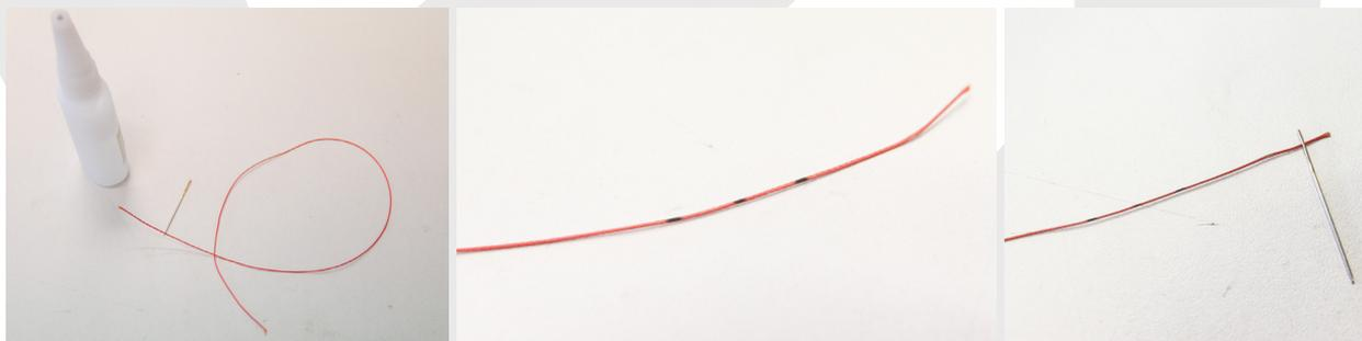
Utilisez une aiguille à tapisser à extrémité ronde et de la colle cyanocrylate liquide.
