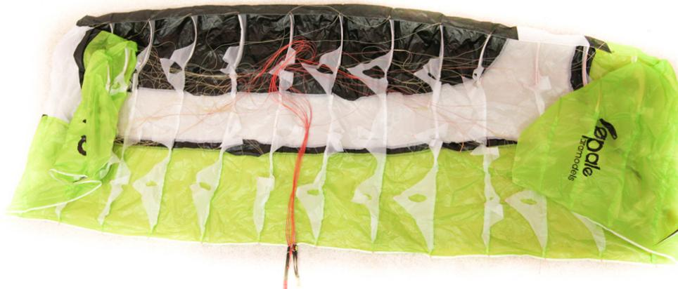
Amenez les extrémités de l'aile vers le centre de la voile. Disposer les élévateurs en bas du caisson central afin de ne pas mélanger les suspentes éviter que celles-ci débordent de l'aile.
