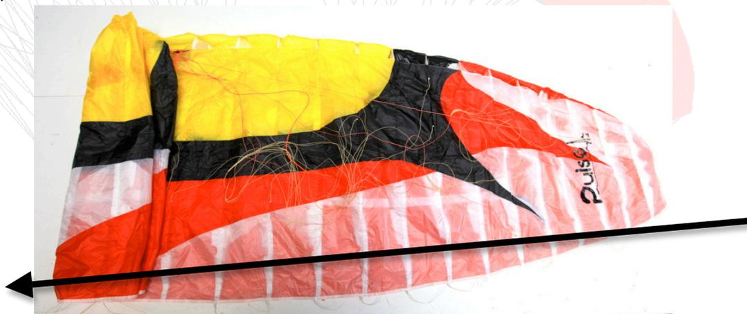
*Ramener les extrémités de l'aile vers le centre. Disposer les élévateurs de cette manière, afin de ne pas les mélanger aux suspentes.*
