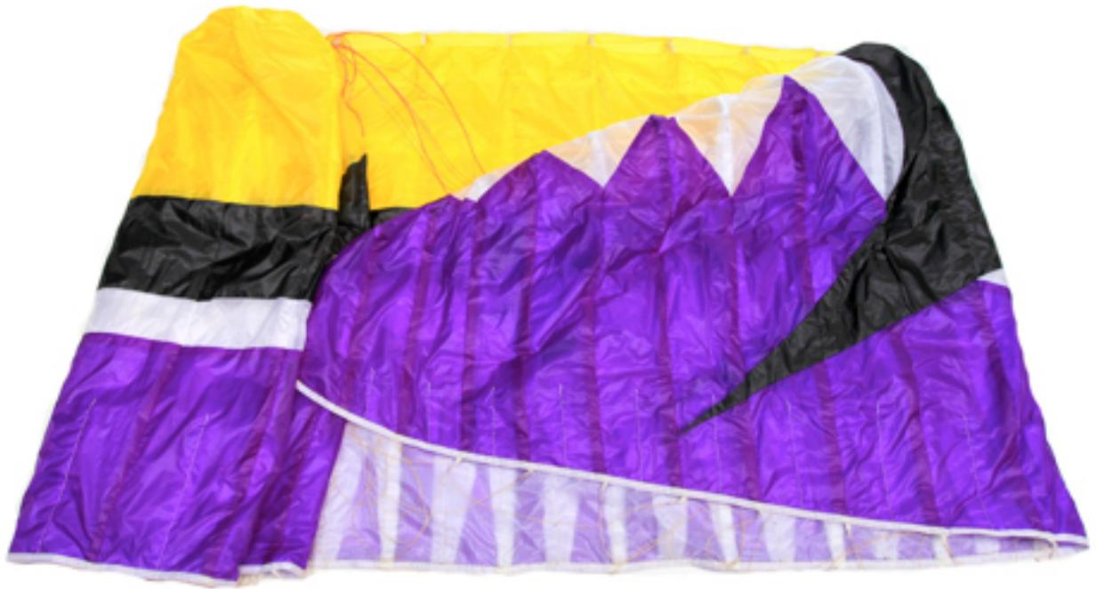
*Positionner les élévateurs sur l'aile, puis replier la sur elle-même en 2 fois (environ une largeur de main)
