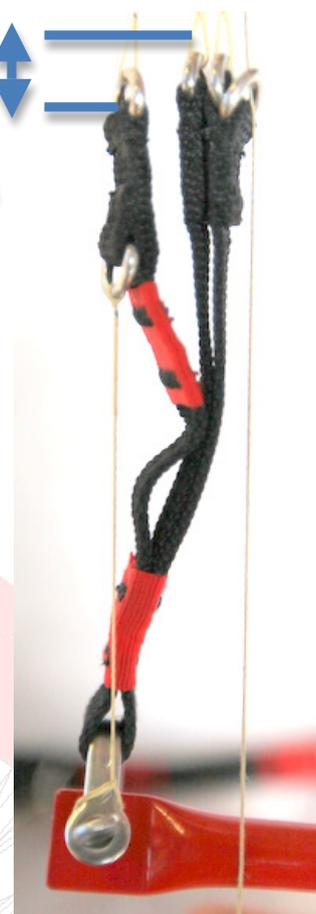
Vos élévateurs sont alors dans cette configuration, avec un décalage d'environ 10mm :
