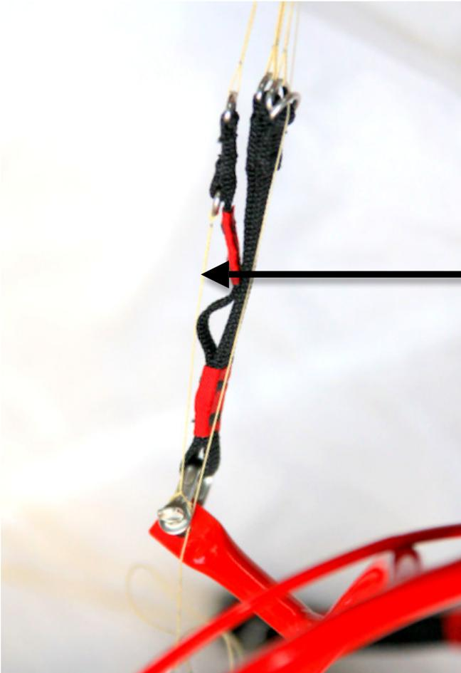
Le montage des élévateurs part du même principe que pour l'utilisation vol de pente. C'est à dire, la marque rouge située sur la sangle doit se trouver vers l'avant du chariot. Le nœud qui maintient la suspente de frein doit être retiré, et la suspente de frein doit passer librement dans l'anneau prévu à cet effet.
