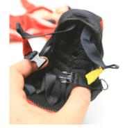
Munissez vous de la sellette et ouvrez la fermeture du compartiment arrière. Glissez les jambes du pilote dans les sangles et passer les cables des servos dans l'orifice dorsale de la sellette afin d'avoir la connectique dans le compartiment arrière
