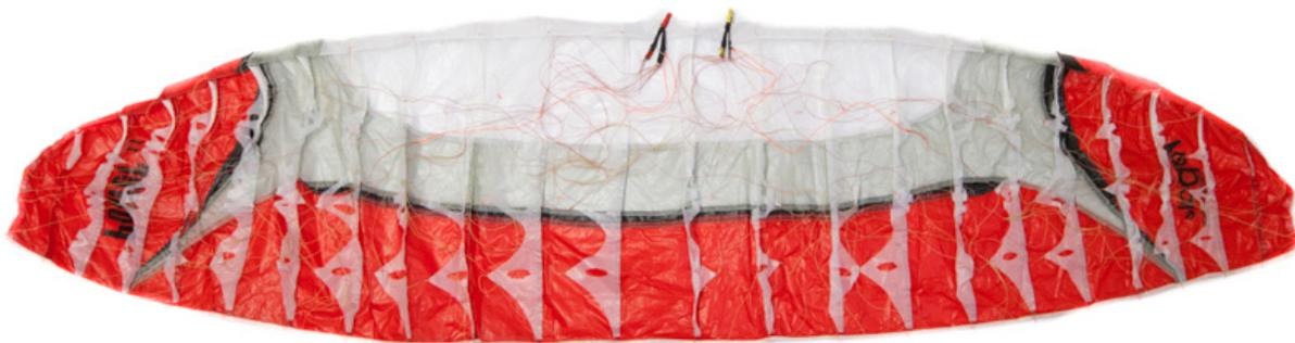
Amenez les extrémités de l'aile vers le centre de la voile. Disposer les élévateurs en bas du caisson central afin de ne pas mélanger les suspentes éviter que celles-ci débordent de l'aile.
