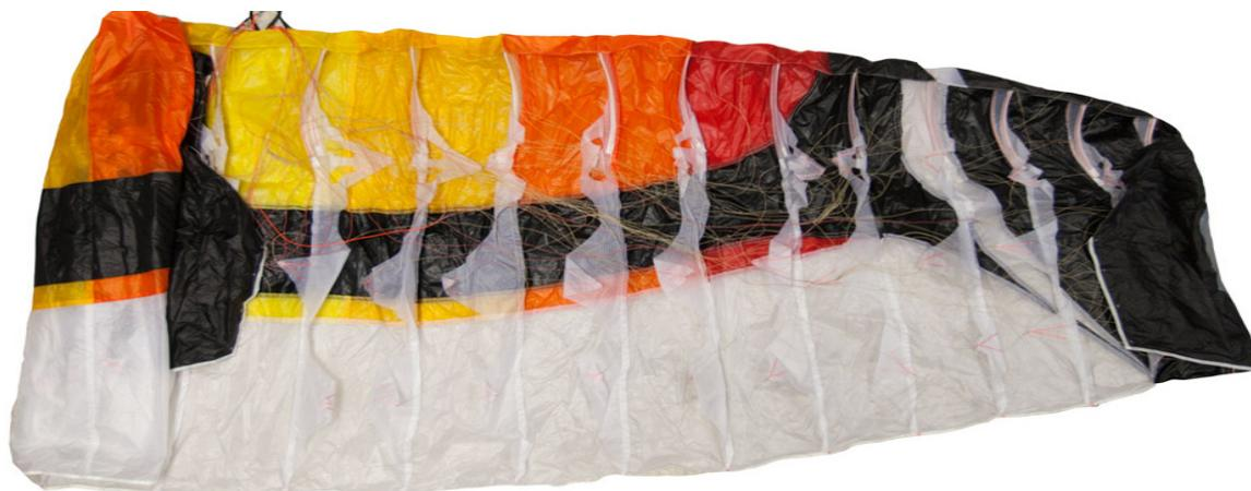
Amenez les extrémités de l'aile vers le centre de la voile. Disposer les élévateurs en bas du caisson central afin de ne pas mélanger les suspentes éviter que celles-ci débordent de l'aile.
