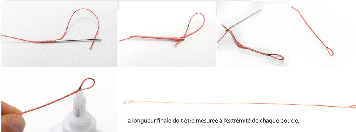
la longueur finale doit être mesurée à l'extrémité de chaque boucle.
