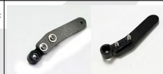
Positionner le servomoteur en butée mécanique haute. Insérer ensuite le palonnier.
