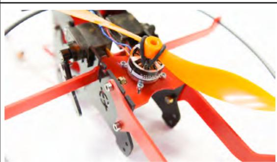
Installer le contrôleur de vitesse sous la platine intermédiaire. Placer ensuite du velcro adhésif sur la platine inférieure.
