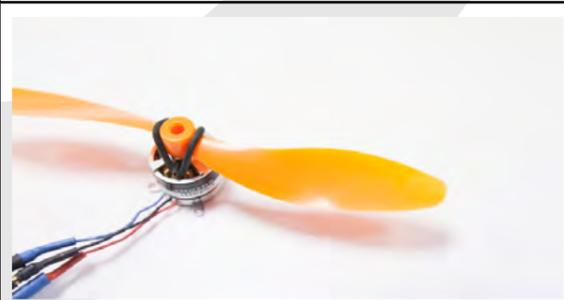
Monter le moteur à l'aide de 4 vis cruciforme M2x8
