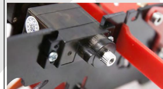
Effectuer le montage du bras sur le palonnier du servomoteur à l'aide de 2 vis cruciforme fournies avec le servomoteur . L'opération doit être réalisée avec symétrie pour le bras opposé
