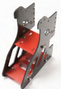
Insérer le hauban horizontal en le glissant au dessus du logement de servomoteur
