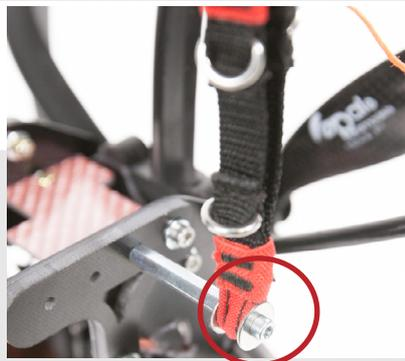
Dénouer la suspente de frein fixée sur l'élévateur de votre aile.
