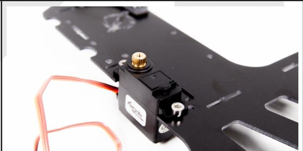
Monter la platine basse sur le flanc gauche à l'aide de 2x vis CHC M3-8, 2x rondelles et 2x écrous frein.
