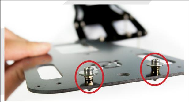
Positionner les fixations de jambes sur la platine dorsale. Les fixer à l'aide de vis CHC M4-12 et écrous freins M4.
