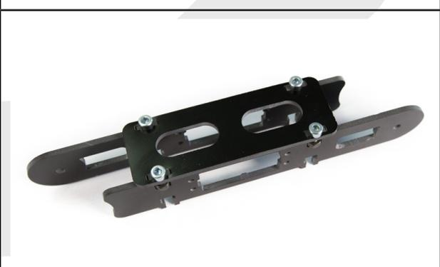
Apposer la pièce inférieur ( identique à la pièce supérieure), avec 4 vis CHC M4-12 et écrous freins.
