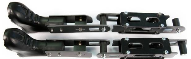
Pour raccorder la jambe sur le tronc, le genou ainsi que l'angle formé entre la jambe et le tronc doit être à 90°. Verrouiller le tout à l'aide d'une vis CHC M4-12.
