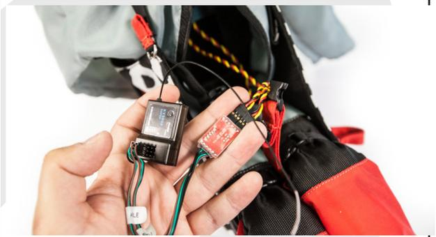
Positionner le récepteur, le mixeur et la batterie de réception à l'intérieur du tronc du pilote dans l'emplacement prévu à cet effet.
