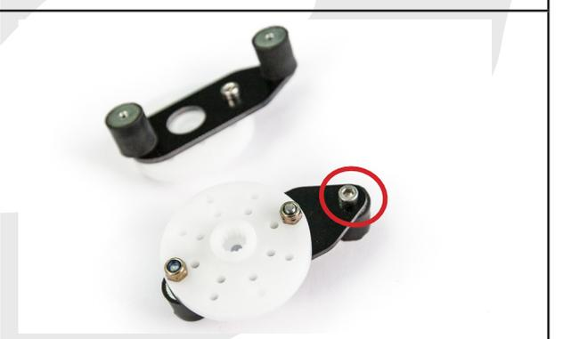
Fixer le bras réalisé en fibre à l'aide de 2x vis CHC M3-8
