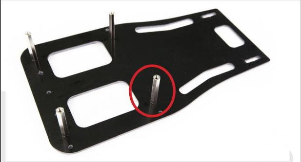
Comme l'image ci-contre, apposer 4 vis CHC M3-8 avec écrous freins M3 sur cette même platine. Ces vis auront pour rôle par la suite de maintenir en place les servomoteurs.
