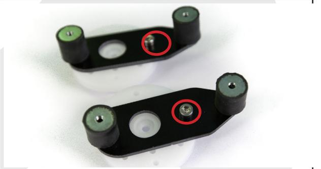
Fixer le dernier silentbloc (celui-ci ne possède pas de tige filetée), à l'aide d'une vis CHC M3-8.
