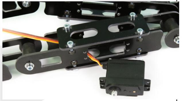
Verrouiller le servomoteur à l'aide de 2 vis CHC M3-8 et écrous freins M3.
