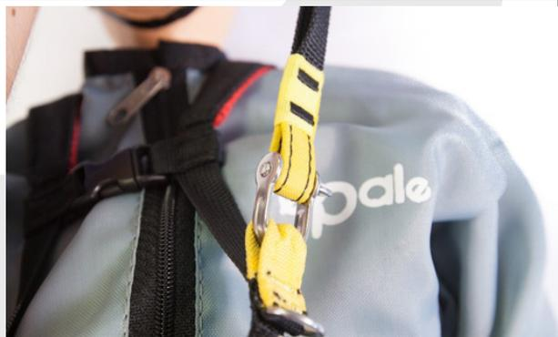
Raccorder la suspente de frein sur la poignée en effectuant un noeud simple puis une boucle.
