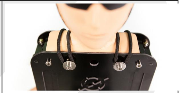
Cet élastique permet de fixer la tête du pilote, mais principalement de la rendre mobile lors d'un fort impact au sol. Ainsi vous limiter énormément le risque d'endommager la tête du pilote
